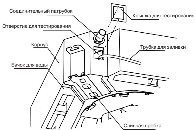
2. Включите питание и запустите кондиционер в режиме охлаждение. Прислушайтесь к звуку от дренажной трубы. Убедитесь в том, что вода сливается (учитывая длину дренажной трубы, вода может появиться с задержкой примерно на 1 минуту), проверьте герметичность соединений.
